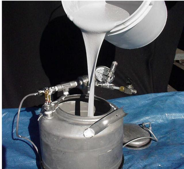
**Figure 3 - Lithium Hydride Slurry**
